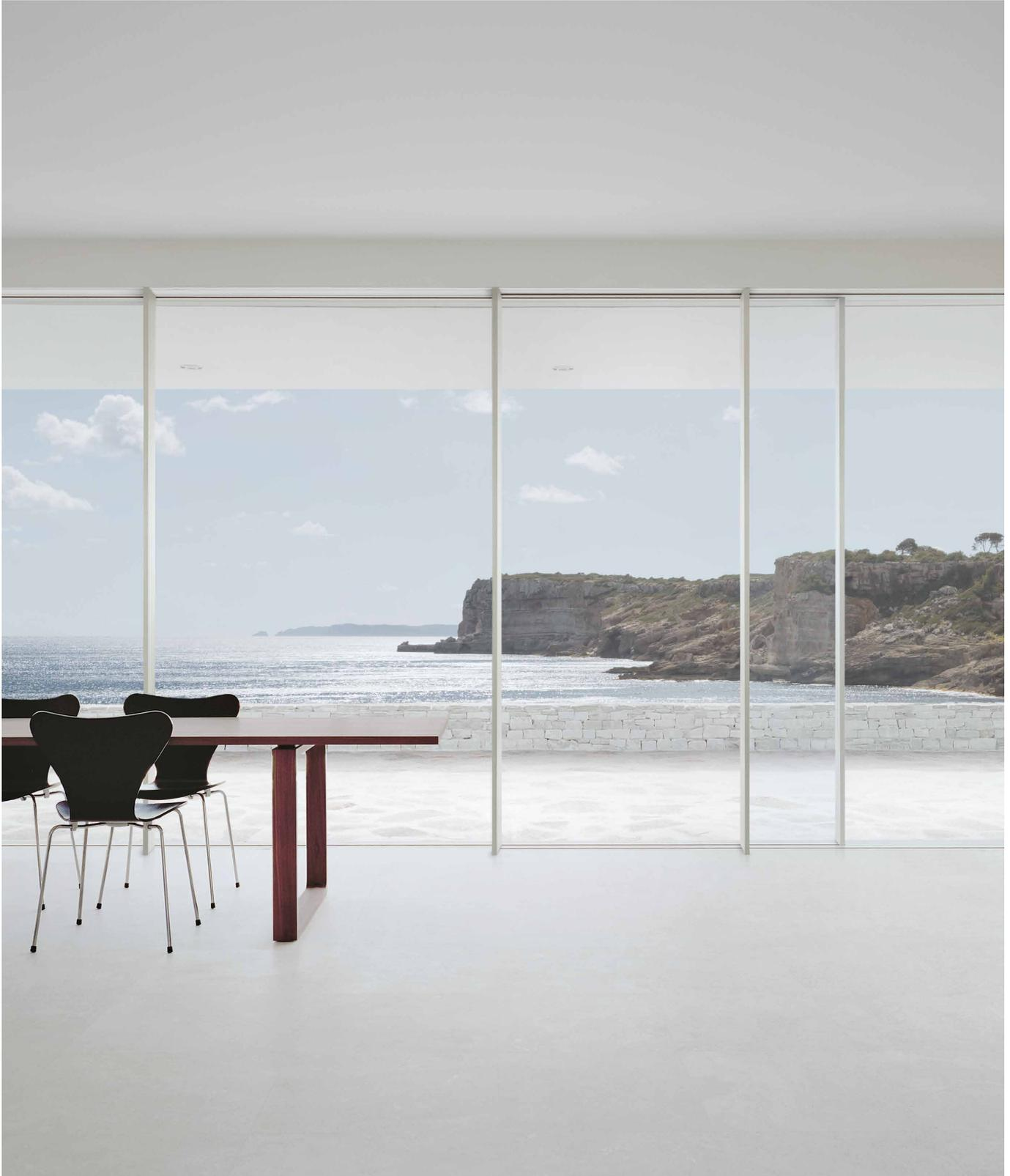
Il sistema Sky-Frame viene integrato dal montante in filigrana, con larghezza visibile di soli 30 mm. Disponibile in tre spessori (66/90/110 mm). Per soddisfare requisiti statici superiori è possibile rafforzarlo con fino a quattro inserti in acciaio. Le superfici vetrate fisse senza telaio possono essere così combinate su grandi superfici con finestre scorrevoli, formando una membrana di vetro complanare continua.
