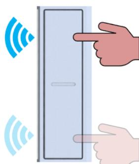
Um die Anlage in der Fahrt zu stoppen, kann eine beliebige Taste des Bedientasters kurz betätigt werden.
