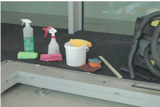
Um die Oberfläche der Aluminiumprofile sauber und den Glanzgrad über viele Jahre erhalten zu können, und somit Voraussetzung für die Garantie-Gewährleistung ist eine sach- und fachgerechte Reinigung und Pflege der beschichteten Flächen.
