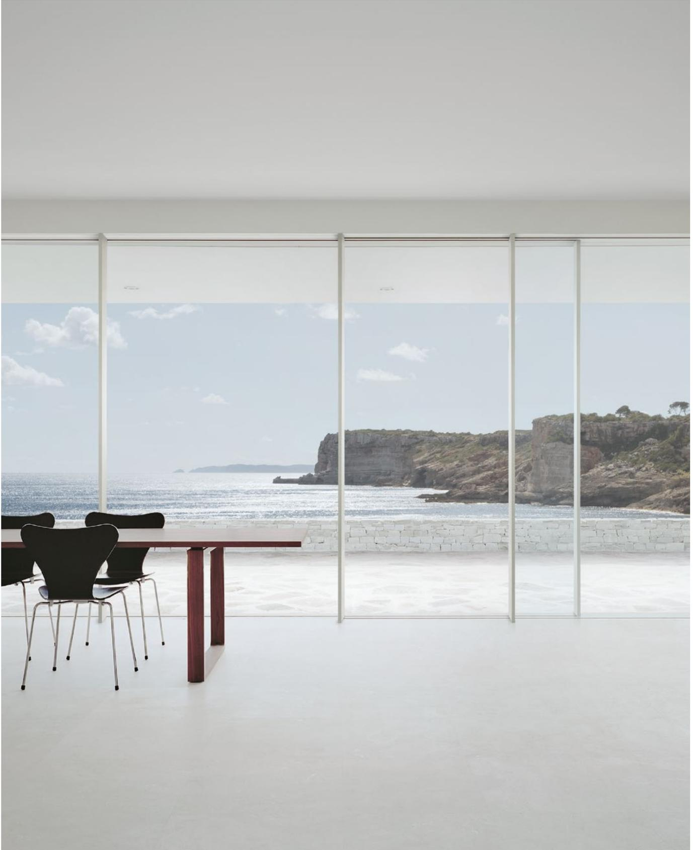
Das Sky-Frame System wird durch den filigranen Pfosten, mit einer minimalen Ansichtsbreite von nur 30 mm, ergänzt. Erhältlich in drei Bautiefen (66/90/110 mm) und für höhere statische Anforderungen mit bis zu vier Stahl-Einschieblingen verstärkbar. Rahmenlose Festverglasungen können so grossflächig mit Schiebefenstern kombiniert werden und bilden eine flächenbündige, durchgehende Glasmembran.
