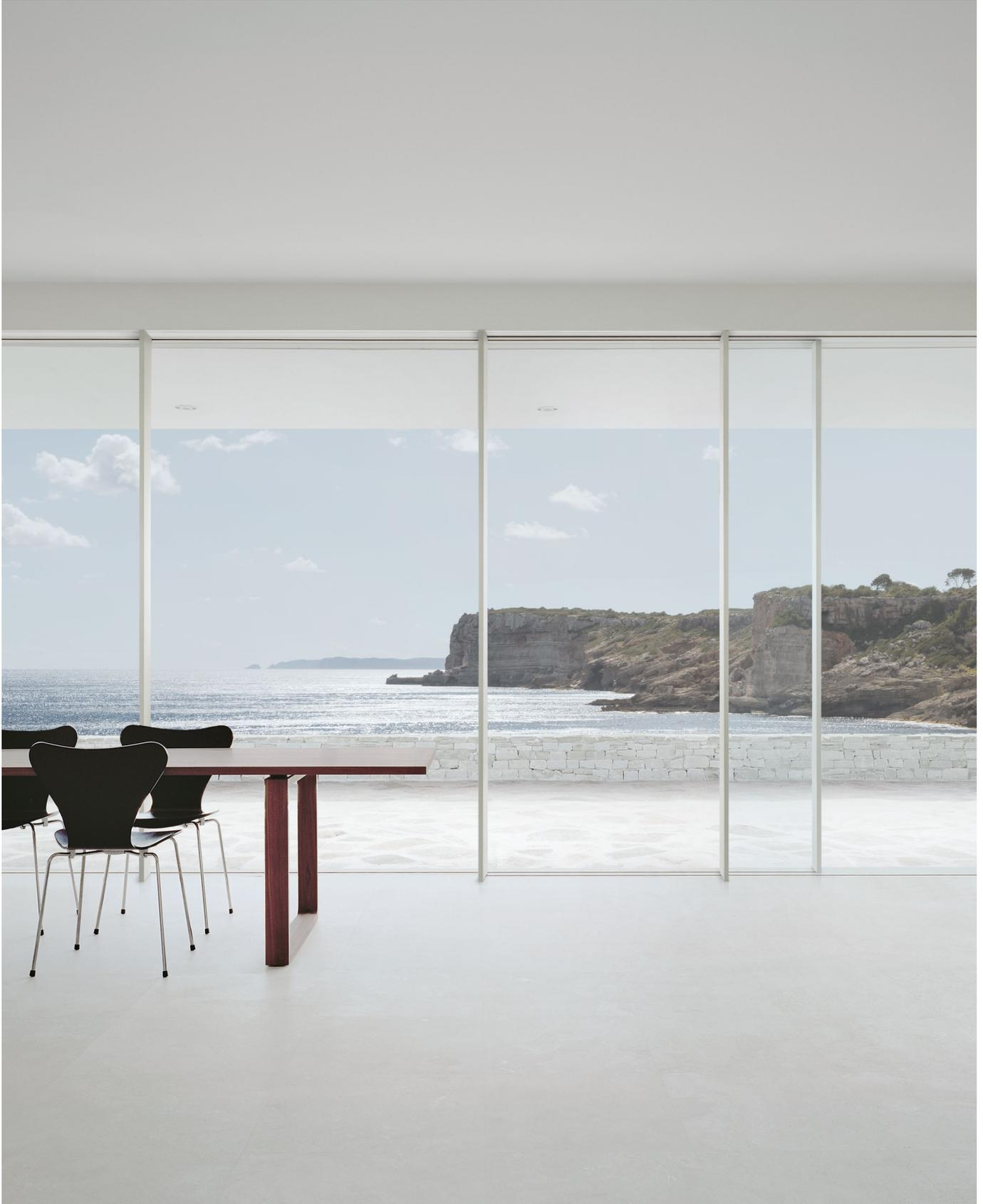
Система Sky-Frame дополняется филигранным вертикальным импостом шириной всего 30 мм. Предлагается с тремя размерами толщины (66/90/110 мм) с возможностью усиления (при помощи максимум четырех стальных вставок) для более высоких требований по статике. Это позволяет комбинировать глухие безрамные элементы остекления с раздвижными окнами, формируя сплошную стеклянную перегородку в одной плоскости.
